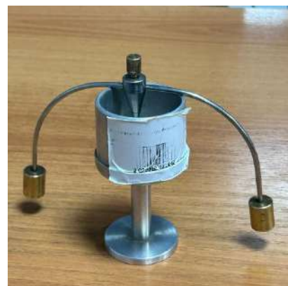
Рисунок 3 – Конус балансирующий Васильева «КВБ»
